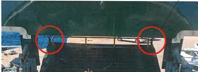
Slika 4. Prikaz vidljivosti poluga (klinova) za mehaničko osiguranje rampe sa zapovjednog mosta (kormilarnice)
