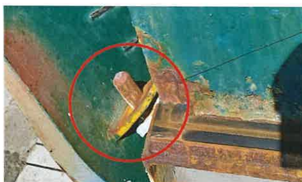
Slika 12. Prikaz bolcena uglavljenog u ušku na lijevoj strani pramčane rampe
