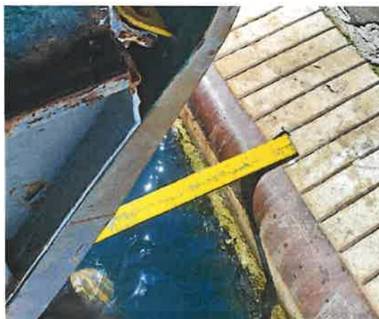
Slika 2. Daska za pristup pramčanom dijelu broda ispred rampe (utvrđeno nakon pomorske nesreće)
