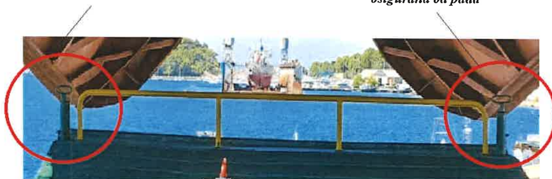
Slika 13. Prikaz položaja poluga (klinova) za osiguranje rampe u donjem položaju
