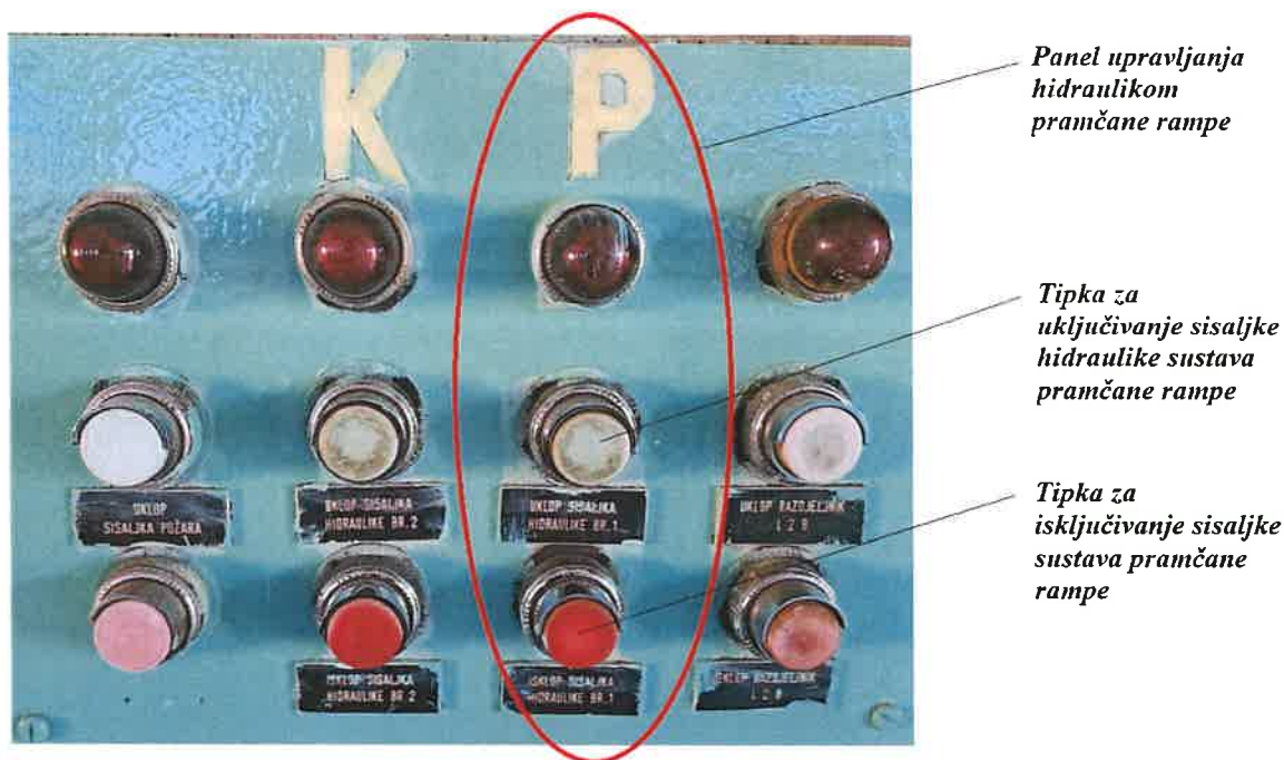
Slika 5. Prikaz panela upravljanja hidraulikom pramčane rampe na zapovjednom mostu (kormilarnici)
